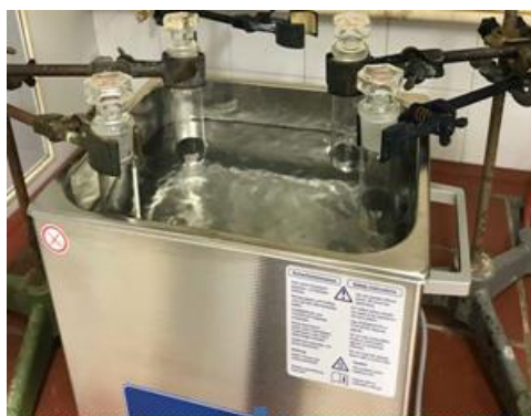
Slika 7. Desorpcija bojila pomoću eutektičkog otapala u ultrazvučnoj kupelji.
