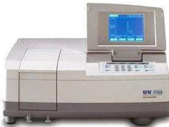
**Slika 11** UV/VIS spektrofotometar, Shimadzu, UV – 1700 PharmaSpec
