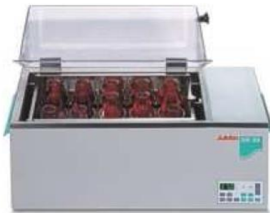
Slika 10 Vodena kupelj s trešnjom JULABO SW-23
