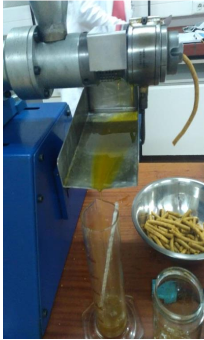
Slika 11 Mjerenje volumena i temperature sirovog ulja
