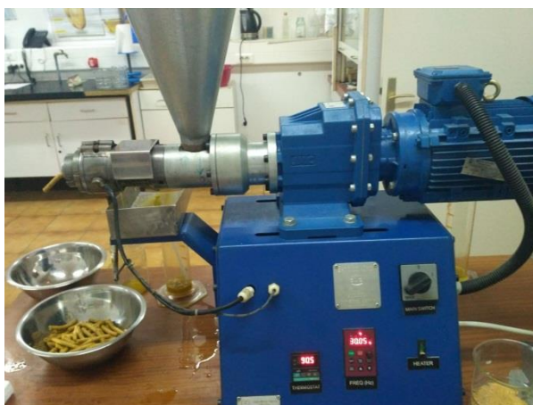
Slika 10 Proizvodnja sirovog ulja i izlaz pogače na kontinuiranoj pužnoj preši
