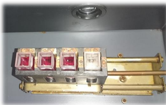
Slika 42 Reakcija glukoze s GOPOD, određivanje intenziteta obojenja spektrofotometrijski
