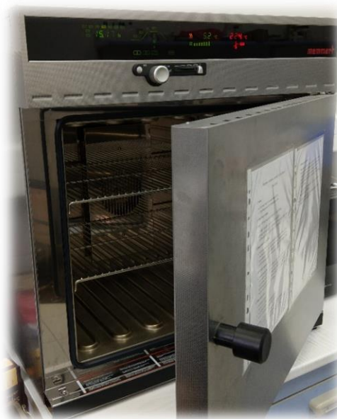
Slika 30 Sušionik Memmert UFE 500 (Schwabach, Njemačka)
