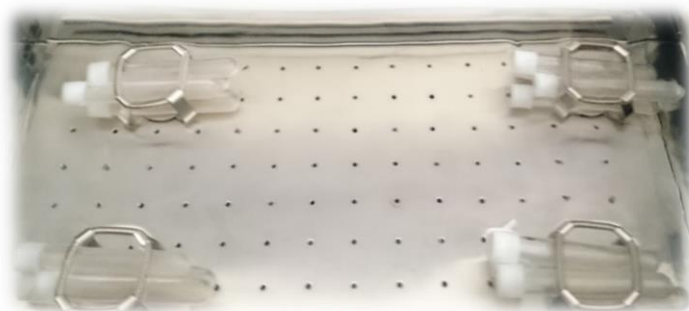
Slika 40 Položaj epruveta u kupelji s tresilicom za inkubaciju od 16 h
