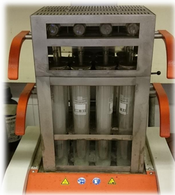
Slika 33 Blok za digestiju s uzorcima nakon spaljivanja
