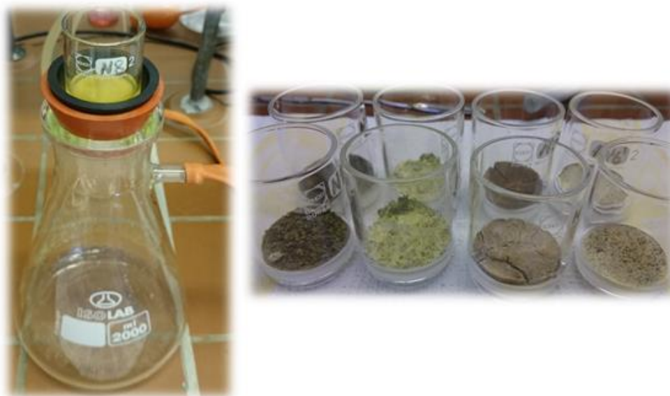
Slika 37 Filtracija netopljivih vlakana i izgled na sinteriranom lončiću prije sušenja
