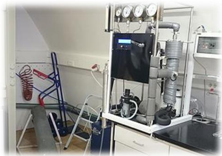
Slika 22 Laboratorijski uređaj za ekstrakciju pomoću SC-CO 2 na Prehrambeno-tehnološkom fakultetu Osijek
