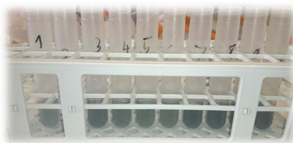
Slika 43 Plavo obojenje nastalo redukcijom Folin-Ciocalteuovog reagensa do volframovih i molbidenovih oksida
