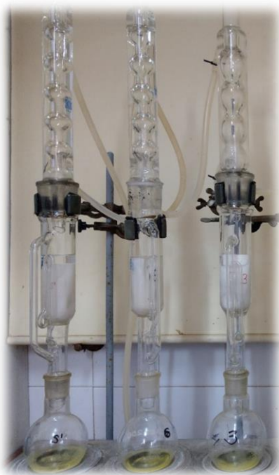
Slika 32 Aparatura za ekstrakciju masti po Soxhletu
