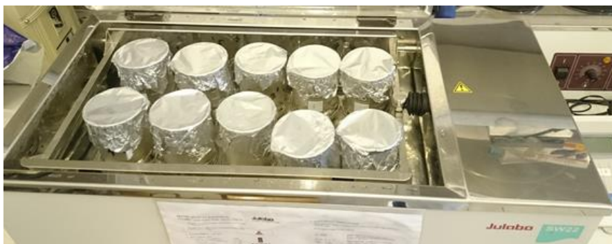
Slika 36 Inkubacija uzoraka u vodenoj kupelji s tresilicom (Julabo SW22)
