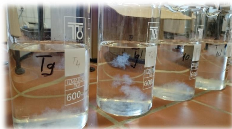
Slika 38 Taloženje topljivih vlakana etanolom
