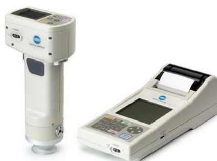
Slika 27 Kromametar Konica Minolta CR-400
