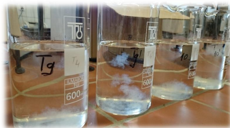
Slika 38 Taloženje topljivih vlakana etanolom
