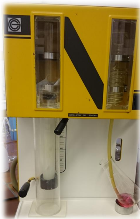
Slika 34 Destilacija na destilacijskoj jedinici
