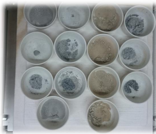
Slika 31 Hlađenje uzoraka na termorezistentnoj ploči nakon spaljivanja
