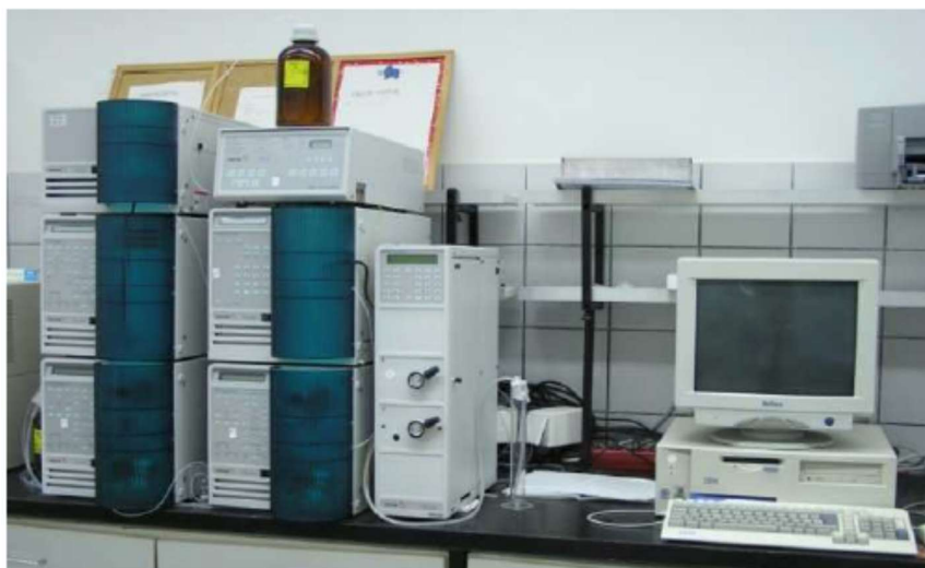
Slika 27 HPLC analitički sustav.
