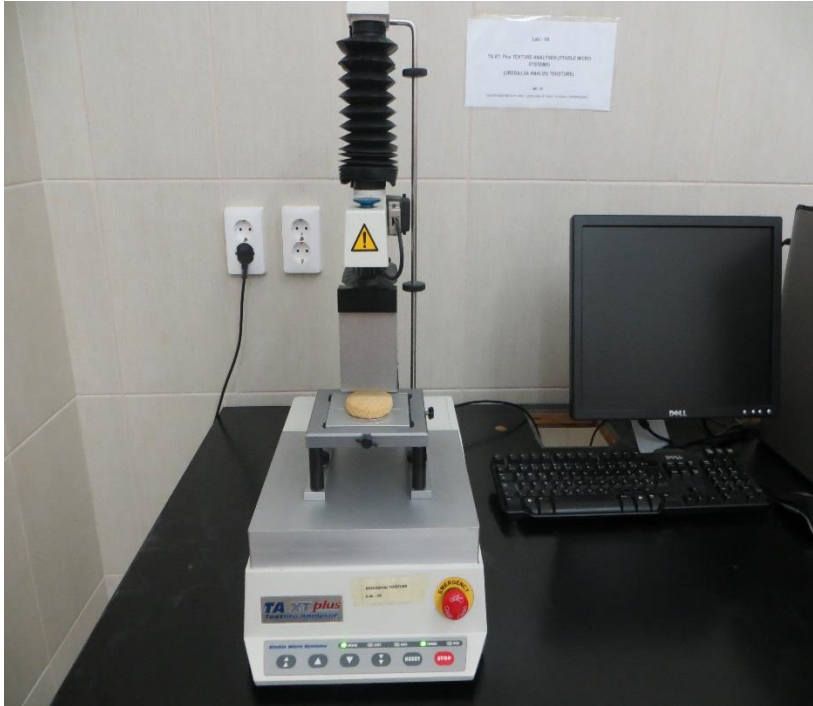
Slika 4 Analizator teksture TA.XT Plus s opremom za lomljenje uzorka
