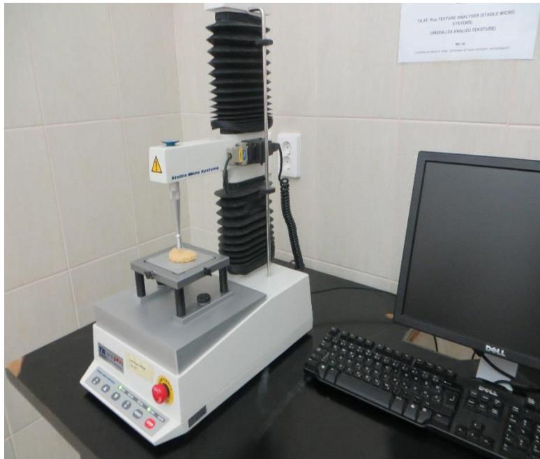
Slika 5 Analizator teksture TA.XT Plus s opremom za prodiranje u uzorak
