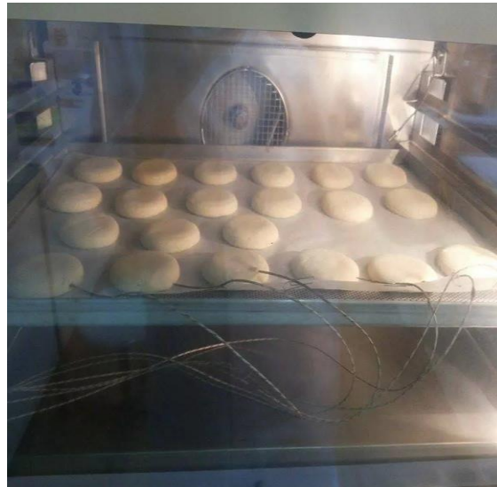
Slika 3 Prikaz postavljenih termoparova u čajna peciva
