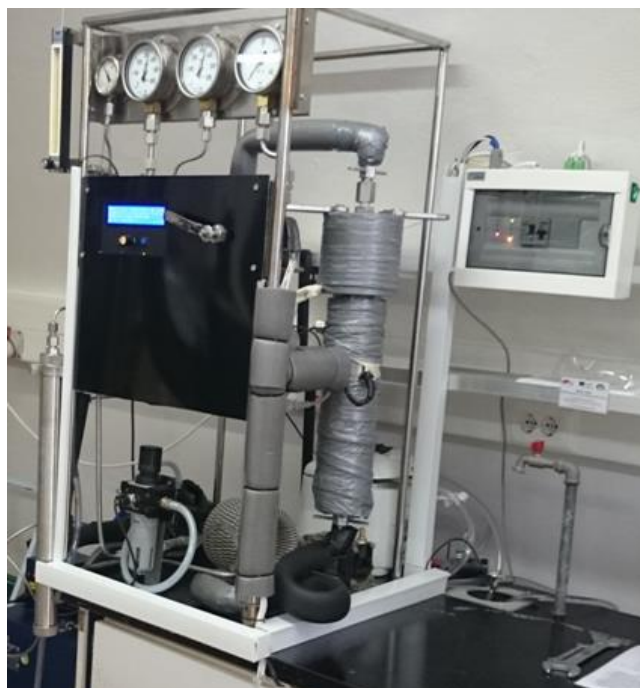
Slika 11 Uređaj za superkričnu ekstrakciju (Osijek, Hrvatska)
