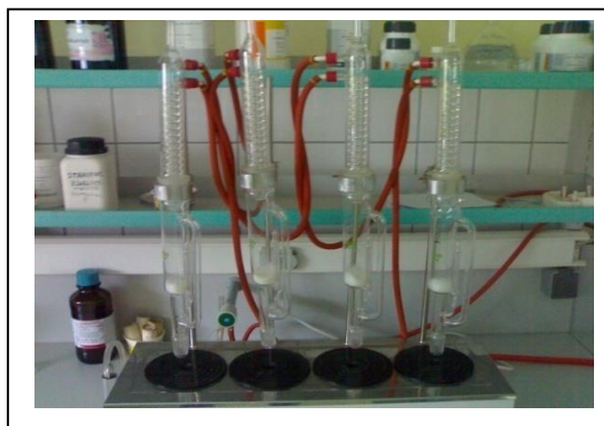
Slika 10 Aparatura za ekstrakciju masti po Soxhletu (Jozinović, 2011.)
