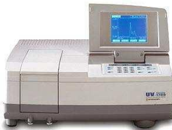
Slika 17 UV/VIS spektrofotometar (Shimadzu, UV – 1700 PharmaSpec) (Babić i sur., 2015)
