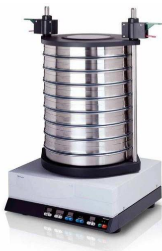
Slika 20 Tresilica za prosijavanje sa standardnom serijom sita Retsch GmbH, AS200 Digit (Babić i sur., 2015.)
