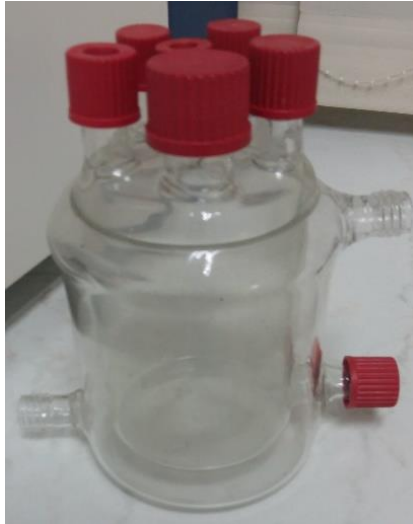
Slika 3.8. Reaktor ( V = 400 \text{ cm}^3 )
