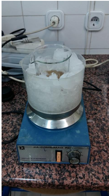
Slika 3.11. Ekstrakt enzima na magnetnoj miješalici tijekom postupka pročišćavanja lipaza
