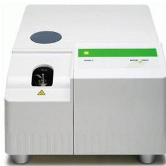
Slika 11. DSC kalorimetar tvrtke Mettler-Toledo model 822e
