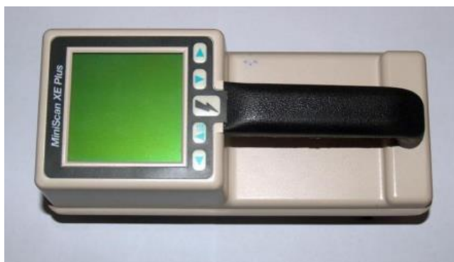
Slika 9. Hunter-Lab Mini ScanXE
