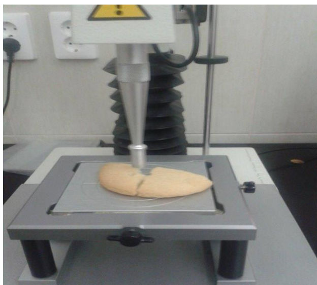
Slika 3. Analizator teksture TA.TX Plus s opremom za prodiranje u uzorak
