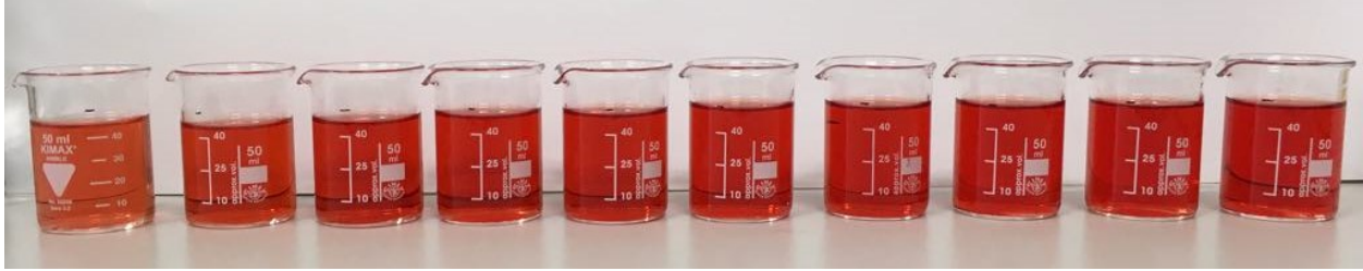
Slika 11. Prikupljeni efluenti nakon adsorpcije kongo crvenila primjenom pivskog tropa veličine čestica 100 – 400 \mu\text{m}
