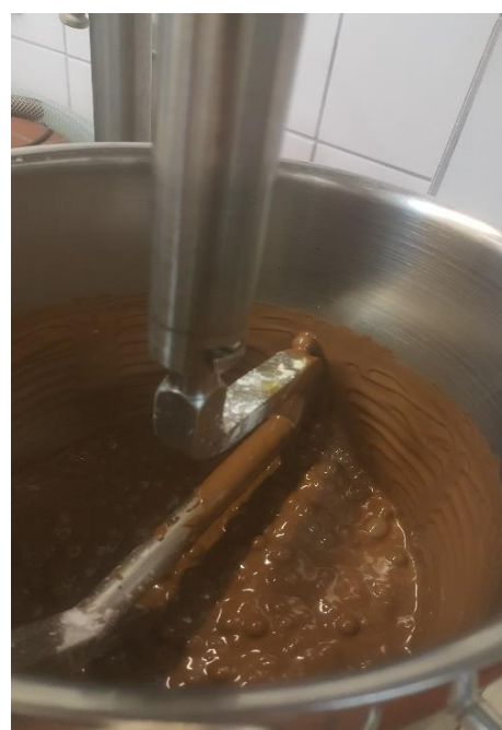
Slika 12 Unutrašnjost kugličnog mlina
