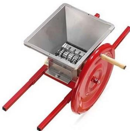
Slika 7 Valjci za usitnjavanje voća (Web 7)
