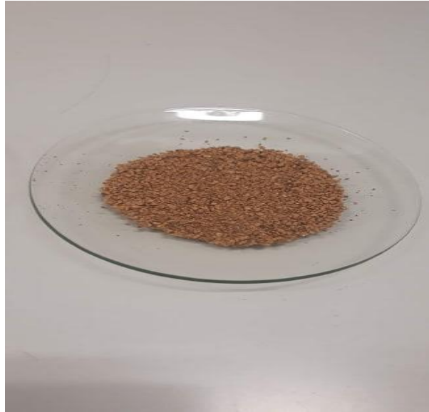
Slika 4 Uzorak samljevene i klasirane ljuske oraha
