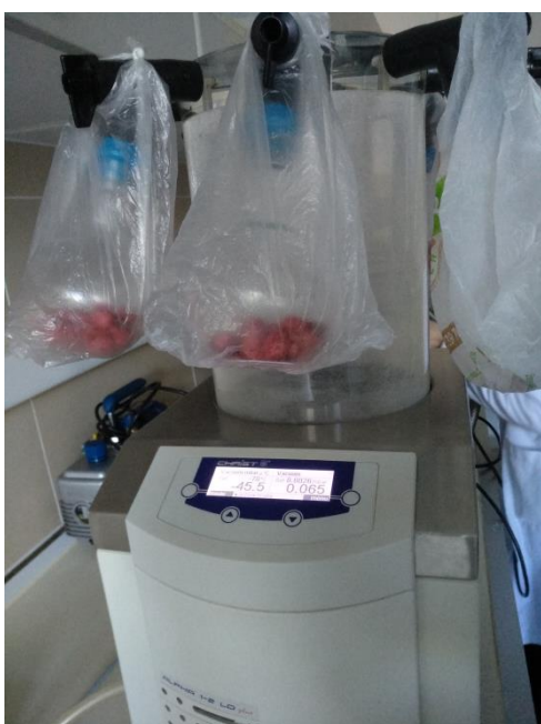
Slika 10 Provedba postupka liofilizacije
