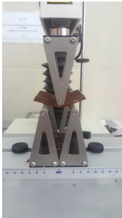
Slika 15 Određivanje tvrdoće čokolade na analizatoru TA.XT Texture Analyser
