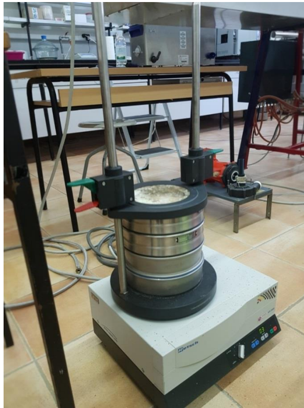
Slika 7 Uređaju za trešnju sita Retsch AS 200
