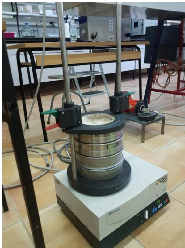
**Slika 7** Uređaju za trešnju sita Retsch AS 200
