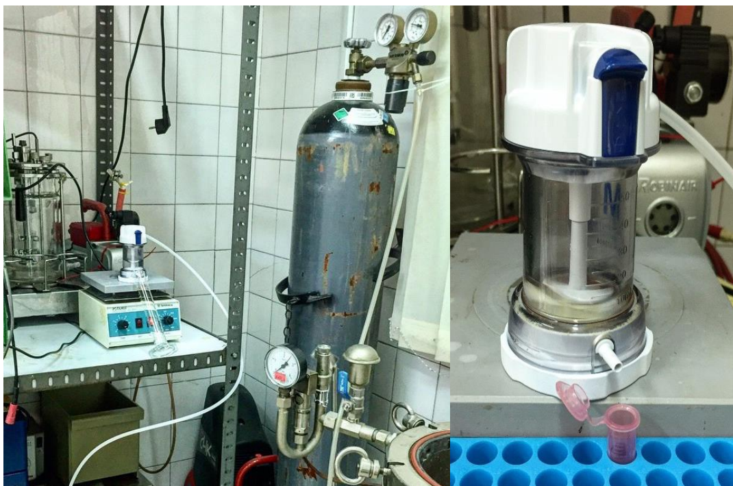
Slika 4 Prikaz membranske ultrafiltracije
