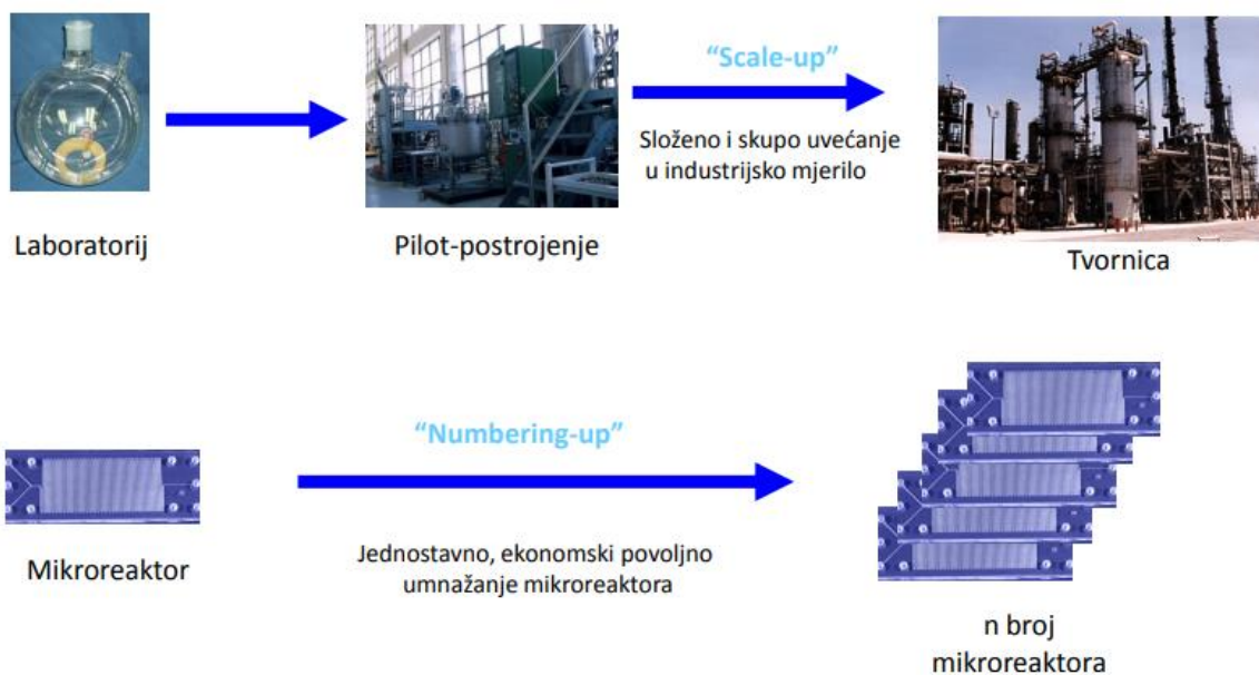
Slika 4 Usporedba metodologije uvećanja procesa kod makrosustava i mikroreaktora (Tišma, 2008.)
