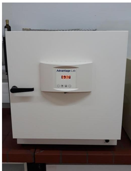
Slika 16 Sušionik za provedbu Oven testa na 63 °C
