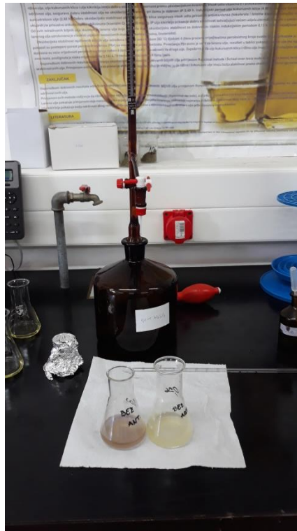
Slika 18 Određivanje peroksidnog broja
