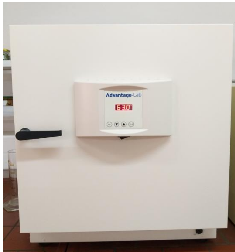
Slika 17 Sušionik (Binder) zagrijan na 63 °C (Izvor: autor)
