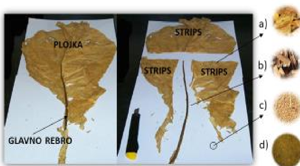
Slika 3 Osušeni duhanski list prije i poslije išiljavanja; a) strips b) duhansko rebro c) duhanska prašina d) refabrikat (Web 2)
