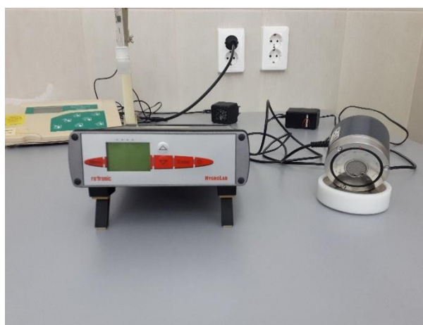
Slika 13. Uređaj Rotronic HygroLab 3 (određivanje aktiviteta vode)
