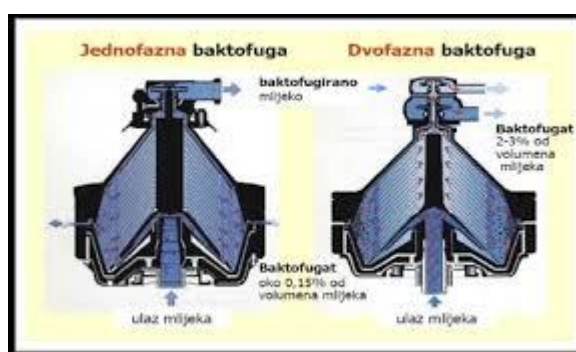
Slika 3. Prikaz jednofazne i dvofazne baktofuge (Preuzeto: https://repositorij.agr.unizg.hr/islandora/object/agr:117/preview )[29.8.2019.]
