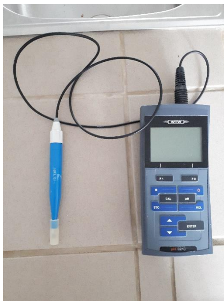
Slika 14. pHmetar WTW™ ProfiLine™ pH 3210
