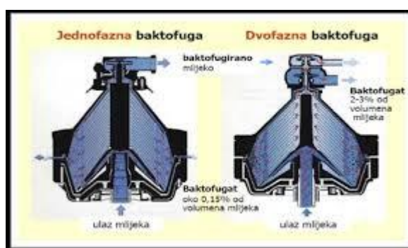
Slika 3. Prikaz jednofazne i dvofazne baktofuge (Preuzeto: https://repositorij.agr.unizg.hr/islandora/object/agr:117/preview )[29.8.2019.]
