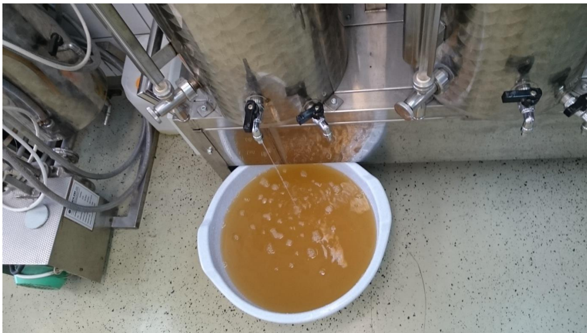
Slika 9. Odjeljivanje mladog vina od taloga (sustav za kontroliranu fermentaciju, SKF 15)
