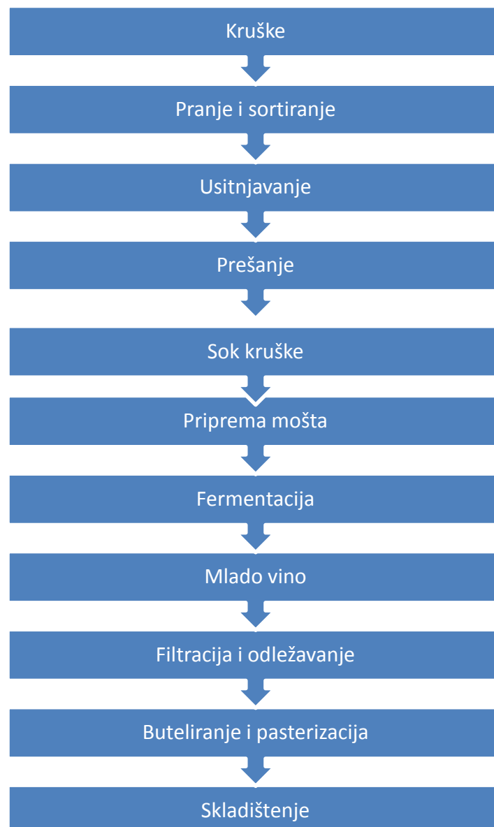
Slika 2. Proces proizvodnje voćnog vina od kruške
