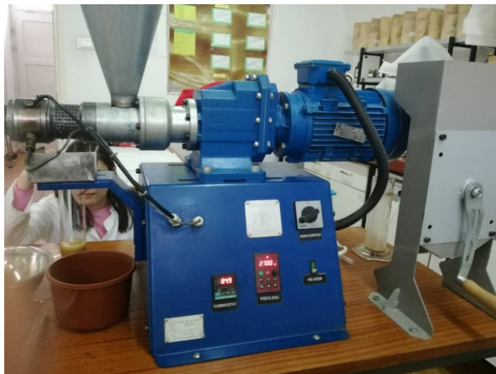
Slika 9 Kontinuirana pužna preša
