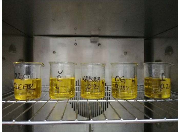
Slika 13 Uzorci ulja u sušioniku za provedbu testa
