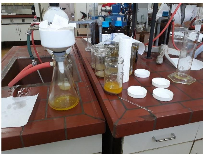
Slika 11 Vakuum filtracija sirovog ulja šafranike
