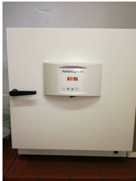
Slika 14 Sušionik zagrijan na 98 °C
