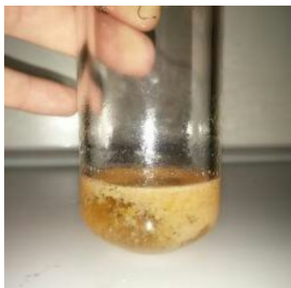
Slika 9 Flokule nastale tijekom postupka izolacije proteina iz meda
