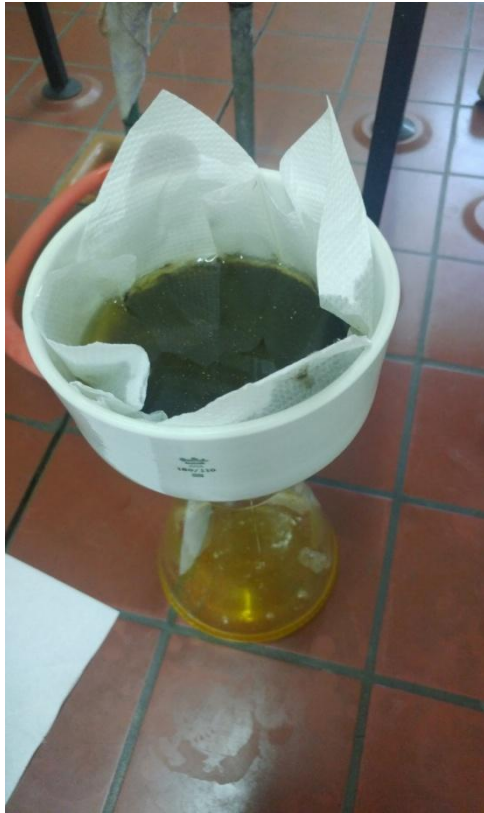
Slika 19 i Slika 20 Vakuum filtracija sirovog ulja sjemenki sikavice
