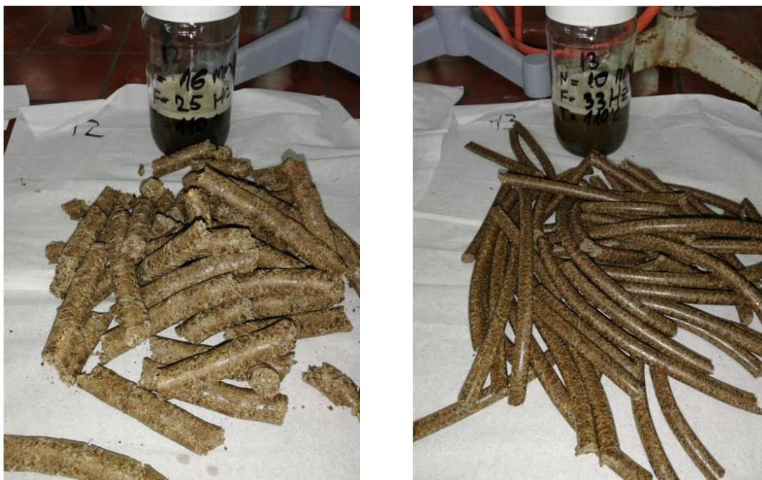
Slika 16 i Slika 17 Sirovo ulje i nusproizvod pogača dobivena prešanjem sjemenki sikavice
