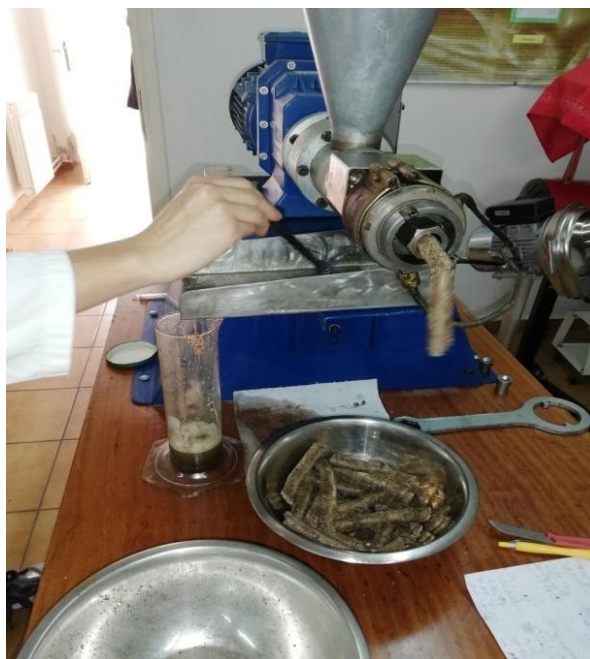
Slika 14 Laboratorijska kontinuirana pužna preša tijekom prešanja
