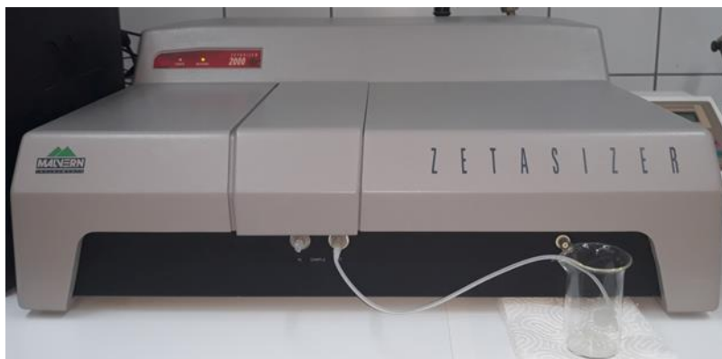
Slika 9 Instrument za mjerenje zeta potencijala Malvern Zetasizer 2000
