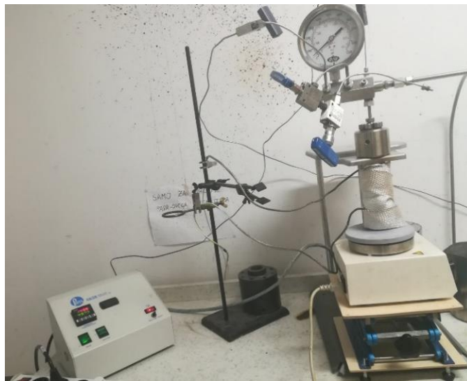
Slika 23 Ekstraktor s vodom u supkritičnom stanju (Parr Instrument Company, USA)
