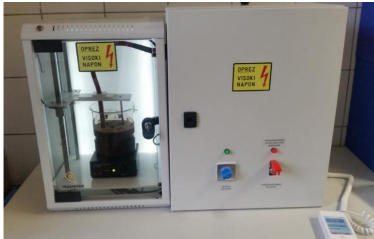
Slika 21 Uređaj za generiranje visokonaponskog električnog pražnjenja (SFE Systems Ltd.)
