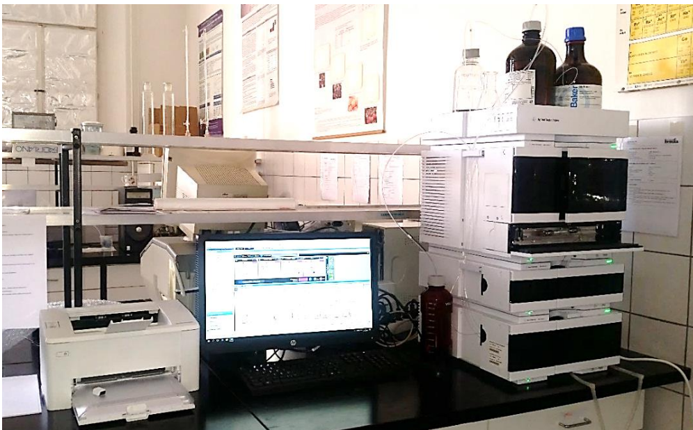
Slika 25 Visoko djelotvorni/tlačni tekućinski kromatograf sa detektorom s nizom dioda (Agilent Technologies 1260 Infinity II, SAD)
