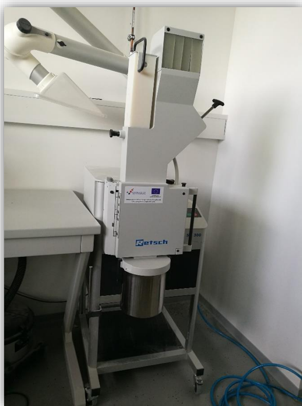
Slika 17 Mlin za usitnjavanje i homogenizaciju uzoraka SM 300 (Retsch, Njemačka)
