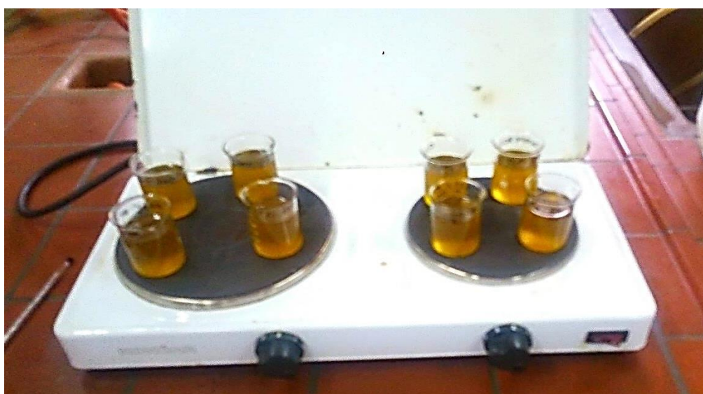
Slika 9 Priprema uzoraka ulja za provedbu testa
