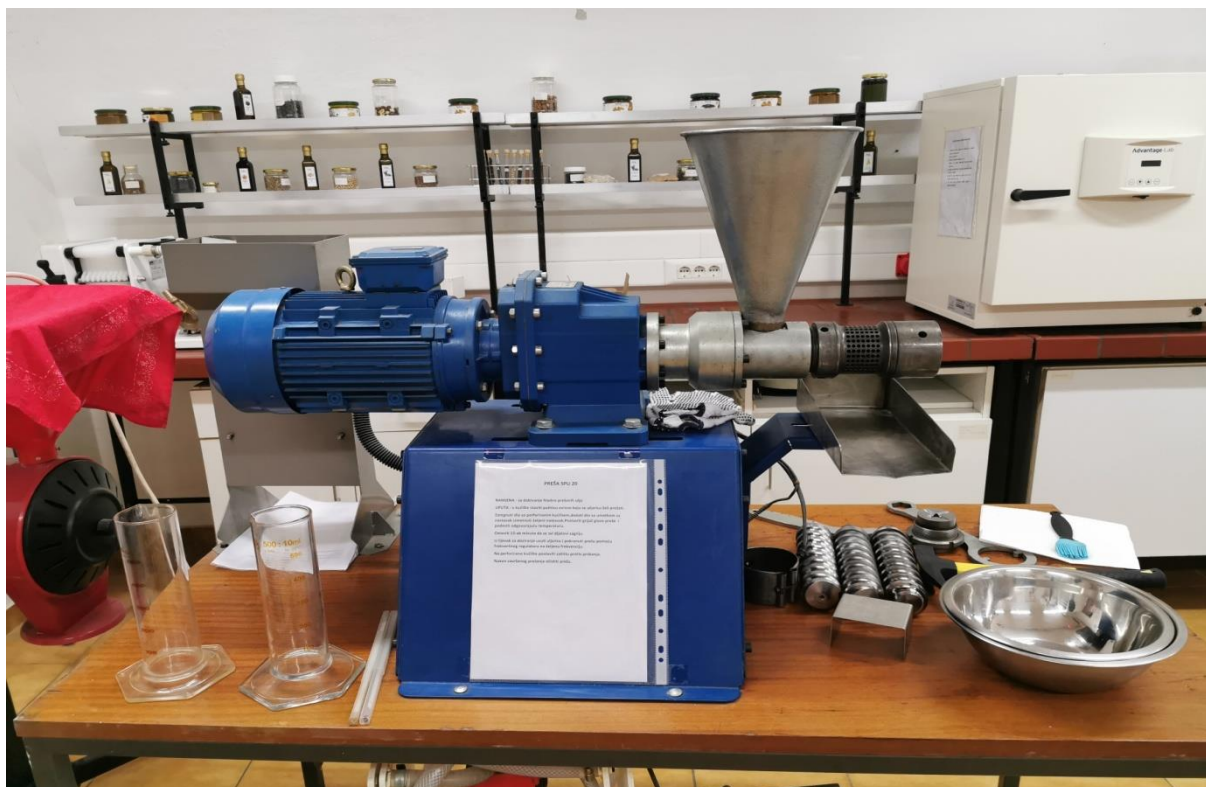
Slika 7 Laboratorijska kontinuirana pužna preša proizvođača ElektroMotor-Šimon d.o.o.
