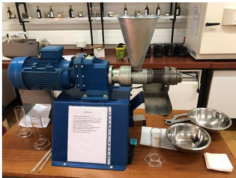
Slika 8 Laboratorijska kontinuirana pužna preša
