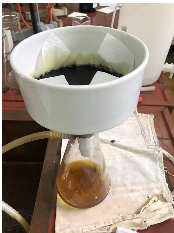
Slika 12 Vakuum filtracija sirovog ulja crnog kima
