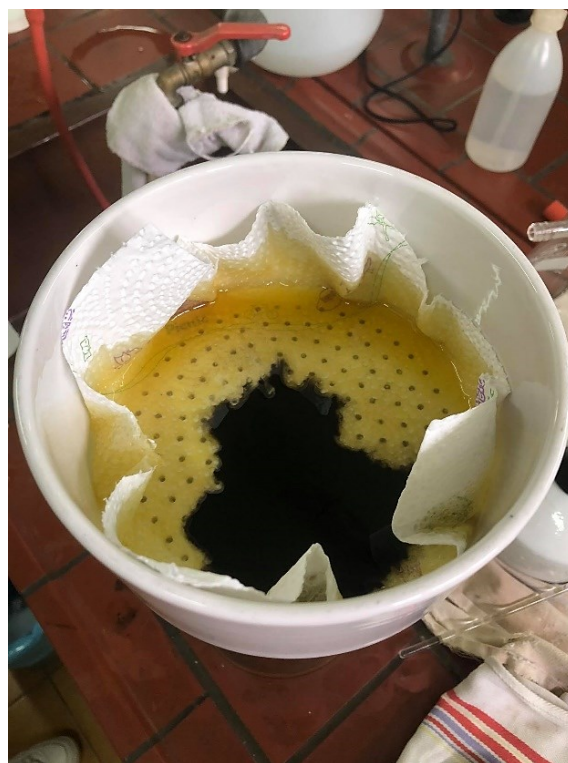
Slika 12 Vakuum filtracija sirovog ulja crnog kima
