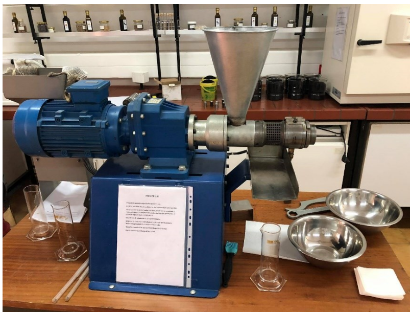
Slika 8 Laboratorijska kontinuirana pužna preša
