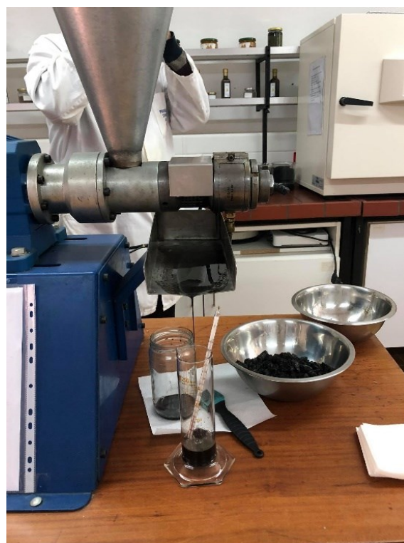
Slika 10 Izlaz sirovog ulja i pogače
