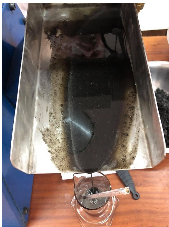
Slika 9 Izlaz sirovog ulja crnog kima i nečistoća
