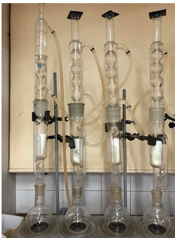
Slika 13 Aparatura za određivanje udjela ulja po Soxhletu
