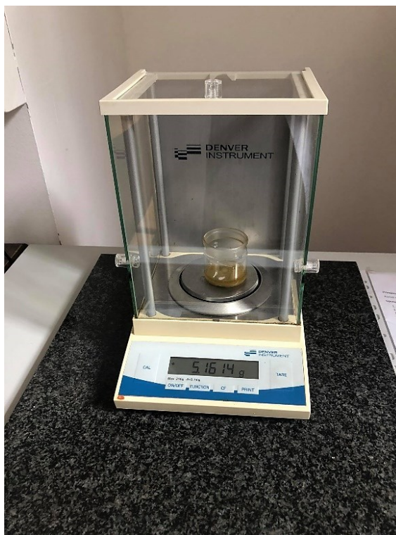
Slika 15 Vaganje uzorka za određivanje vlage
