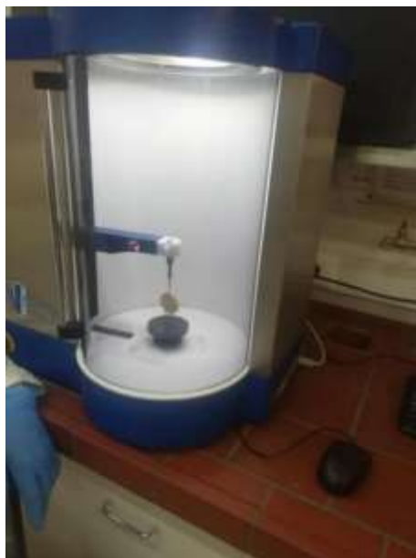
Slika 10: Uređaj za određivanje volumena Volscan profiler
