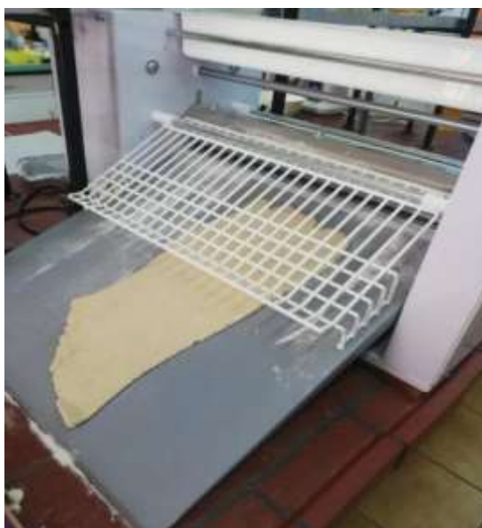
Slika 5: Prikaz laminiranja tijesta na laminatoru
