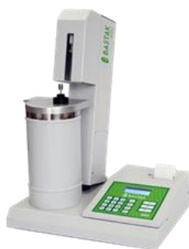
Slika 6 Uređaj po Hagbergu za određivanje broja padanja (Web 1)
