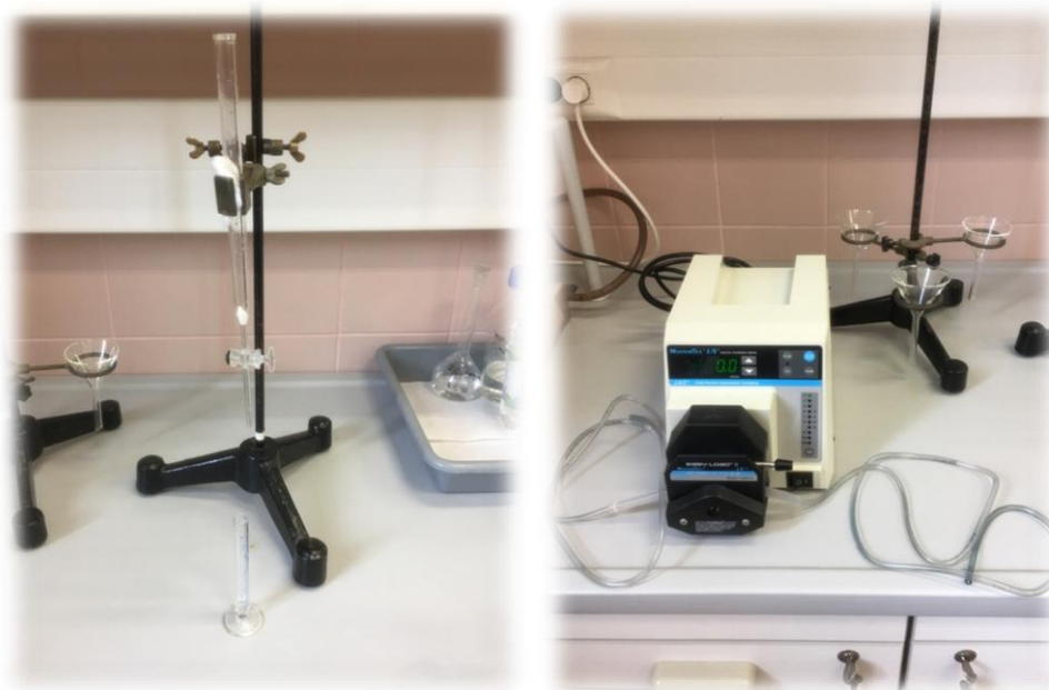
Slika 7 Sustav za ispitivanje adsorpcije arsena u koloni
