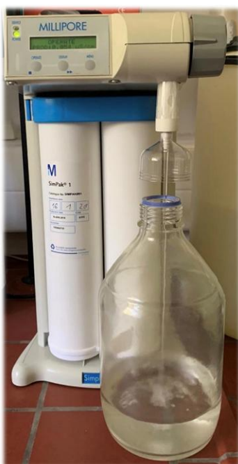
Slika 3 Millipore uređaj za pripremu demineralizirane vode visoke čistoće (milliQ)
