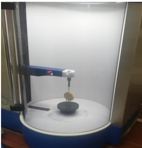
Slika 7. Uređaj za određivanje volumena Volscan Profiler
