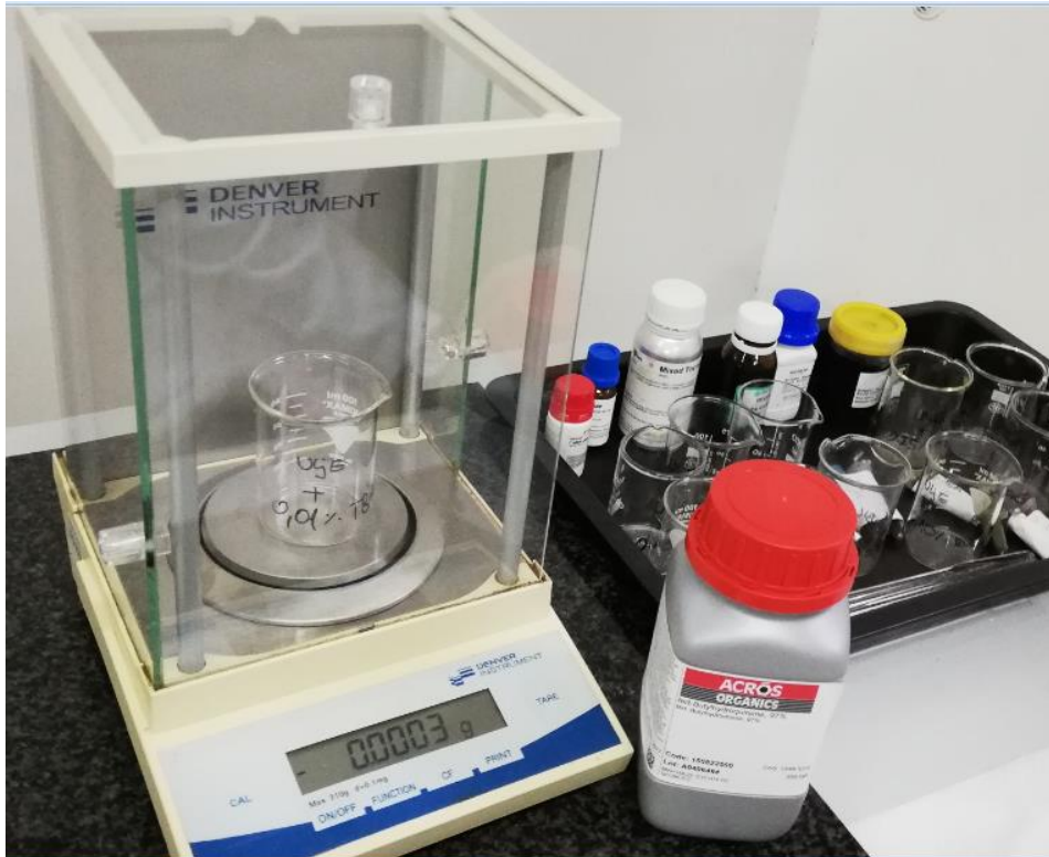
Slika 21. Vaganje i dodavanje antioksidansa u čaše
