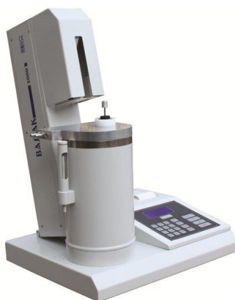
Slika 10 Uređaj po Hagbergu za određivanje broja padanja (Web 2)
