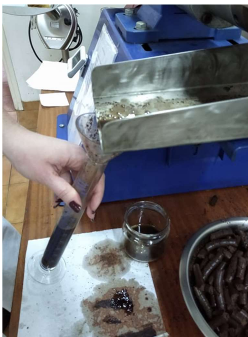
Slika 16 Izlazak sirovog nepročišćenog ulja noćurka
