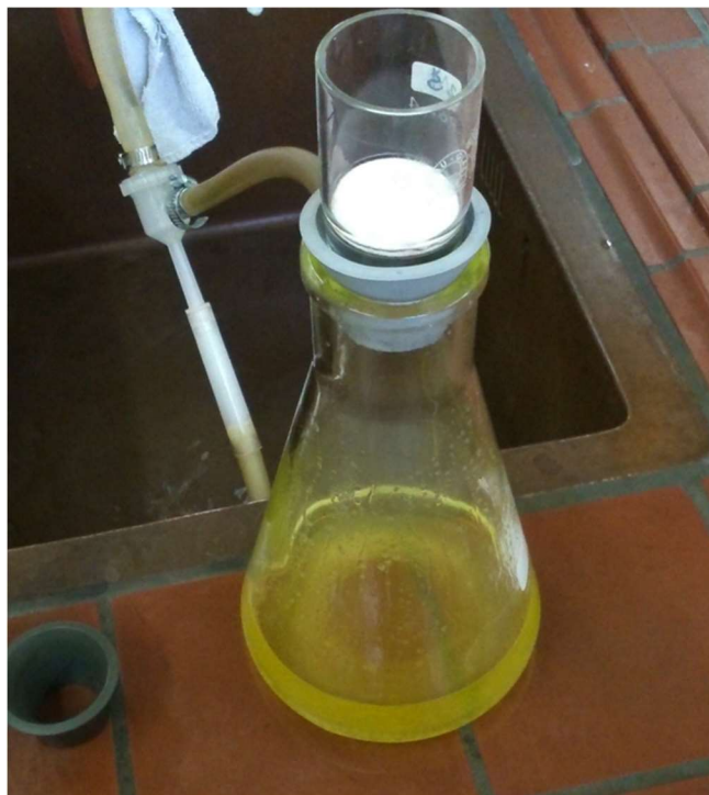
Slika 24 Proces filtracije uz pomoć vakuuma
