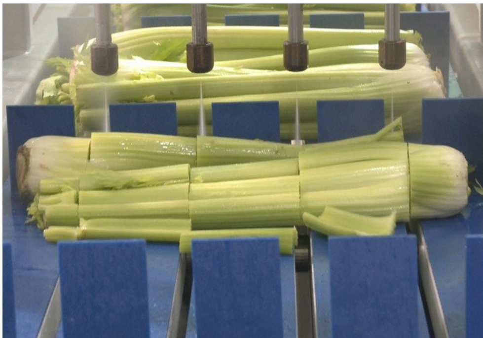
Slika 2 Automatsko rezanje i ispiranje celera
