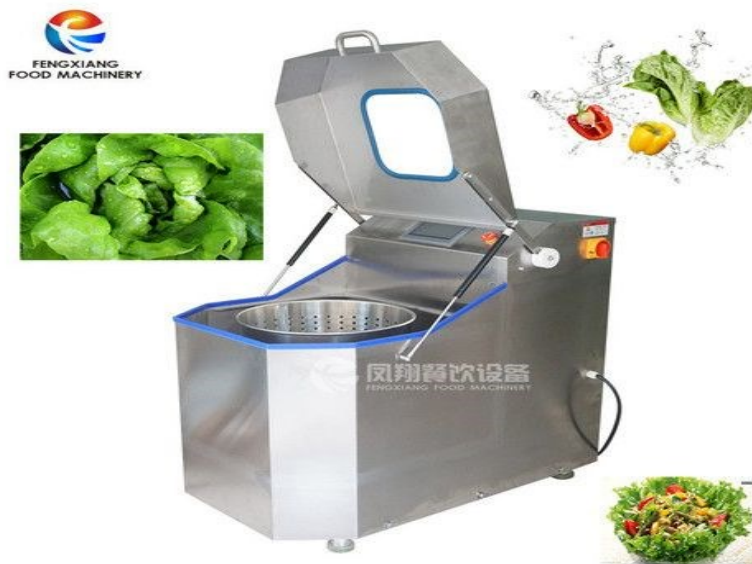
Slika 3 Centrifuga za sušenje povrća
