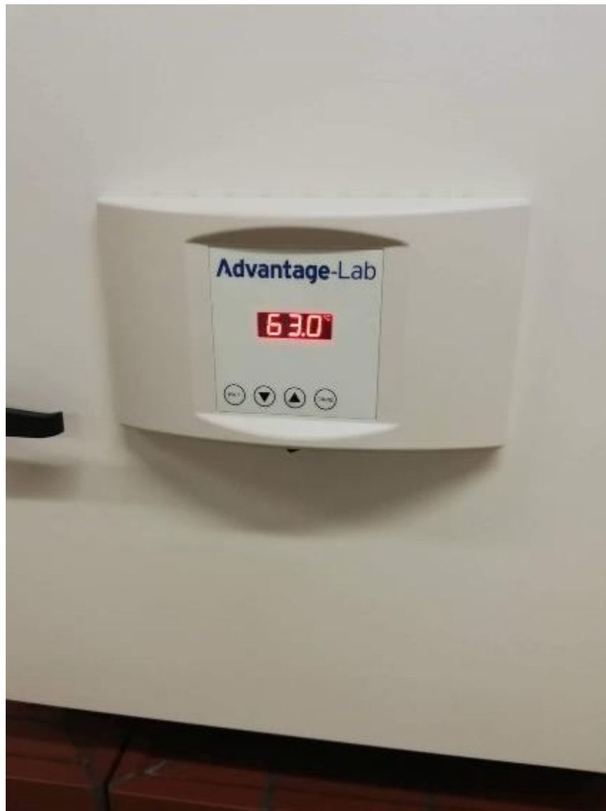
Slika 26 Primjena sušionika za provedbu Schaal Oven testa pri 63 °C
