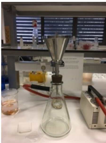
Slika 9. Prikaz vakuum filtracije
