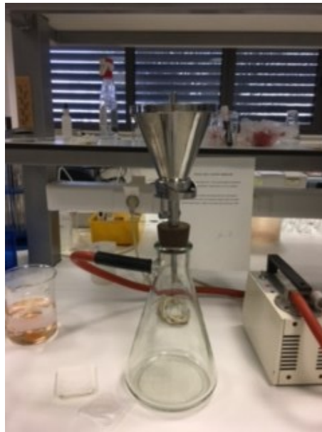
Slika 9. Prikaz vakuum filtracije
