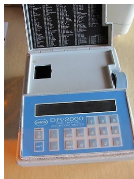
Slika 11. Spektrofotometar model DR/2000, Hach
