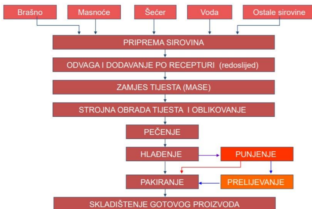
Slika 1 Shema procesa proizvodnje čajnog peciva (Gavrilović, 2011)
