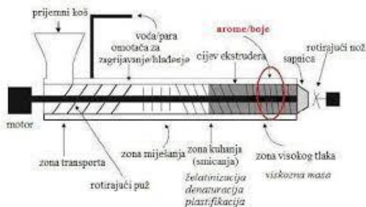
Slika 4 Shema osnovnih dijelova ekstrudera s mjestom dodatka termolabilnih sastojaka
