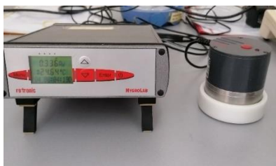
Slika 22 Uređaj za mjerenje aktiviteta vode (HygroLab 3, Rotronic)
