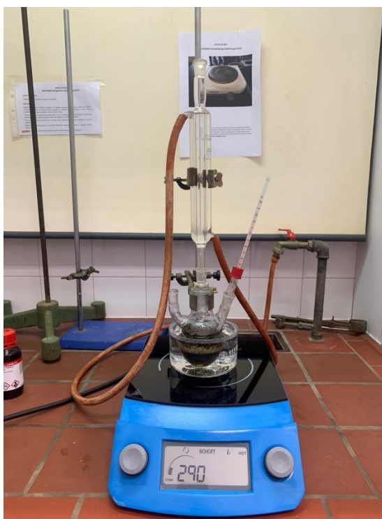
Slika 6: Aparatura korištena za kemijsku modifikaciju ljuske suncokreta
