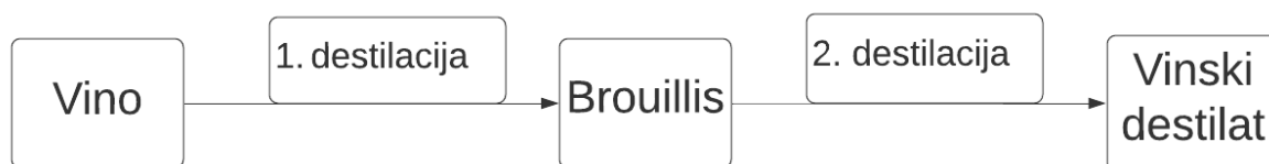
Slika 2 Shematski prikaz dvostruke destilacije
